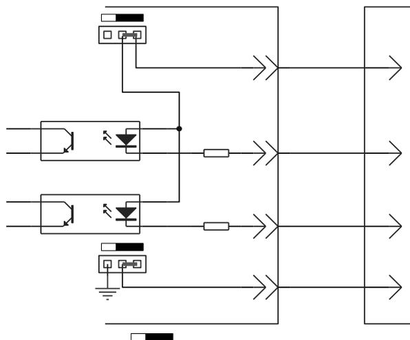
输入信号连接到光耦中 LED 的阴极，需要提供至少 5mA 的拉电流；光电耦合的 LED 阳极连接内部 5V 或外部 EXV 电源，电源范围为+5~+24V。U2 836 内部部使用固定 1.2k 限流电阻，允许在高于 12V 的外部电源工作时，在输入信号上串入电阻以减小触发电流。
