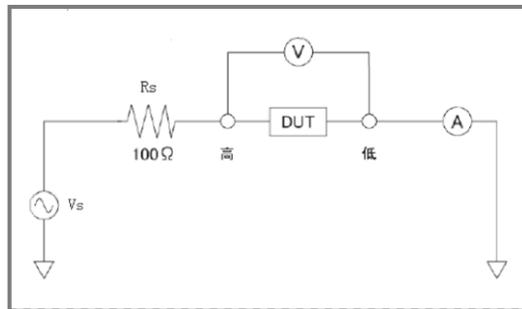
由于输出阻抗的存在，实际被测件 DUT 上的电压电平  $V_{dut}$  或电流电平  $I_{dut}$ ，并非所设置的测试信号电平  $V_s$  或  $I_s$ ，参见第三章测试信号电平的定义：
