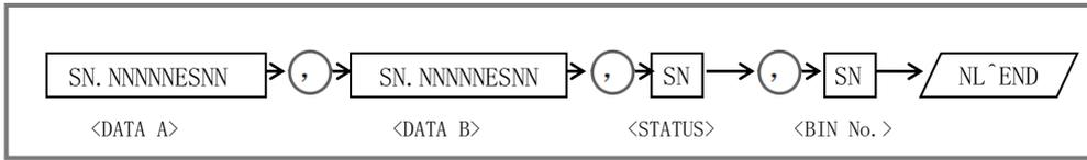
上图中，“，”号为数据间的分隔符，NL 为行结束符 (0x0A)，表示字串结束；^END 为 IEEE-488总线的 EOI (结束) 信号，本仪器从 GPIB 上发送的信息都是在发送行结束符的同时驱动 EOI 信号。RS232C、USB-CDC、USB-TMC 时没有这个信号，只有行结束符。
